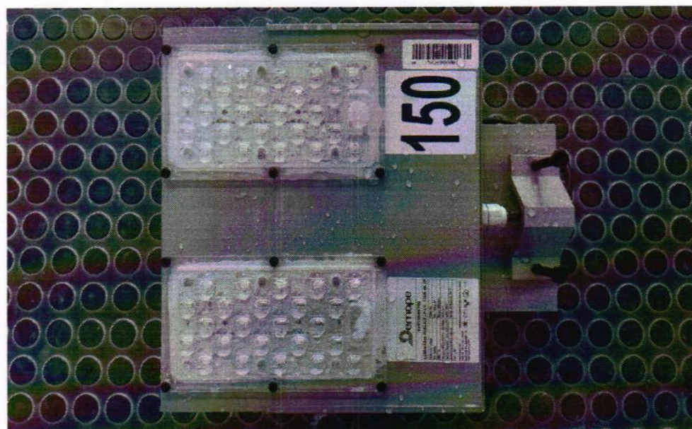
Foto 2 - Ensaio de água.
